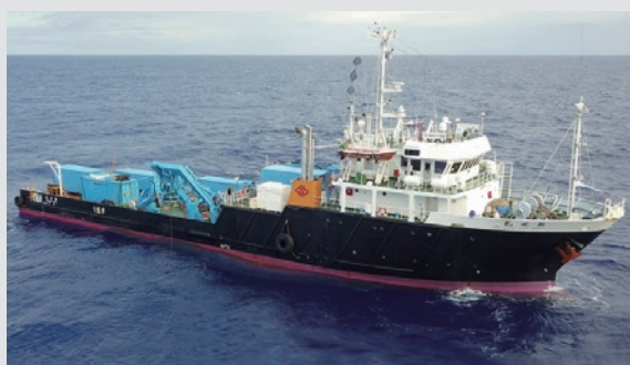
新世丸 全長 60.98m 幅 11.80m 深さ 5.45m 主機馬力 2,000PS×2 総屯数 697t
