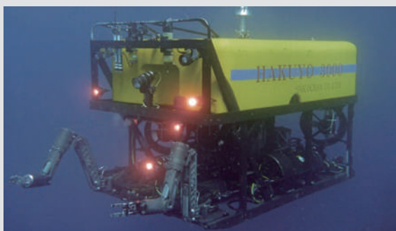
はくよう3000 長さ 3.02m 幅 1.80m 高さ 1.96m ROV重量 5,485kg 潜水可能深度 3,000m
